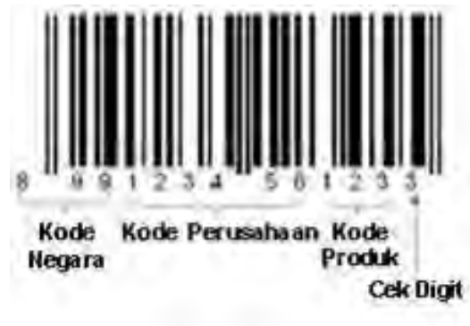
Gambar 4.1 Contoh penomoran barcode (kode garis/Batang)
